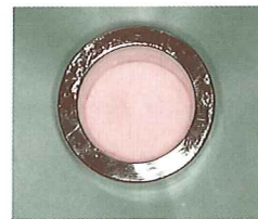
Fig 49 已呈稠狀的樹脂裝入樹脂盒(Resin cup)內
