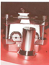
Fig 53 鑄道孔內插入樹脂加壓金屬桿(resin Press Rod)
